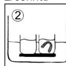
Druckobjekte in einem separaten Gefäß mit frischem SHERAultra-p für maximal drei Minuten im Ultraschallbad reinigen (Gesamtzeit nicht mehr als 10 Minuten!). Zum Trocknen die Bauteile mit Druckluft vorsichtig abblasen.
